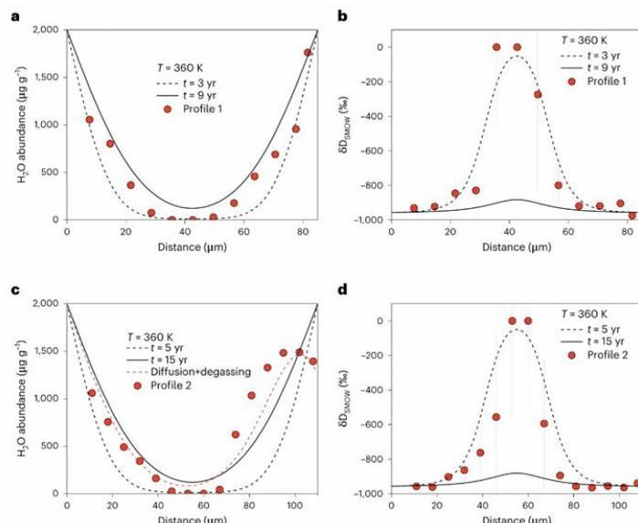
Рис. 4. Значения обводненности частиц, в мкг на грамм вещества (a, c) и изотопного коэффициента водорода  $\delta D_{\text{SMOW}}$ , в ‰ (b, d) по профилям 1 и 2 (см. рис. 3, c). Красные кружочки — экспериментальные данные; черная пунктирная линия — расчетные значения через 5 лет после воздействия; черная сплошная — через 15 лет; красная пунктирная — диффузионно-дегазационная модель. Рисунок из обсуждаемой статьи в Nature Geoscience
