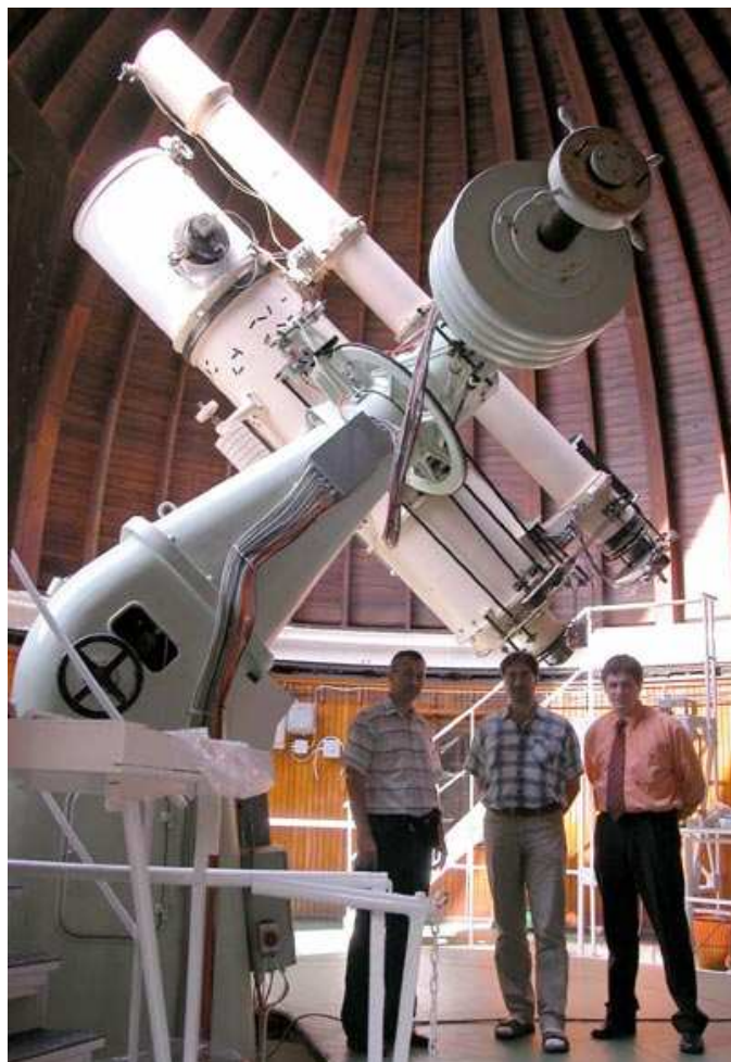
60-см f/6 телескоп Ньютона, произведенный фирмой Цейсс-Хейде в 1928 г. В центре стоит зам. директора обсерватории д-р Петер Абрахам
