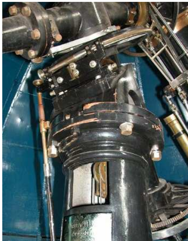
Привод телескопа осуществляется посредством грузов, подвешенных внутри колонны
