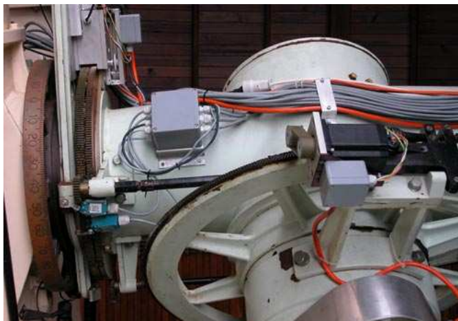
Старинную монтировку вращают современные шаговые двигатели
