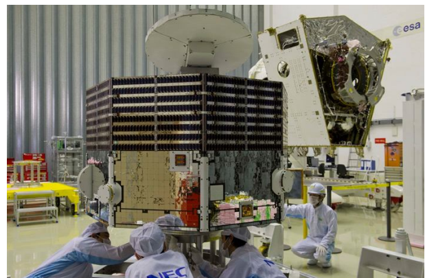
Рис. 6. Магнитосферный зонд MMO в чистом помещении Европейского космического агентства в Нидерландах. MMO был доставлен из Японии в апреле 2015 года. Большой диск, расположенный «на крыше» аппарата — антенна с высоким коэффициентом усиления, которая будет передавать данные на Землю. На заднем плане можно видеть модель транспортного модуля. Фото с сайта sci.esa.int
