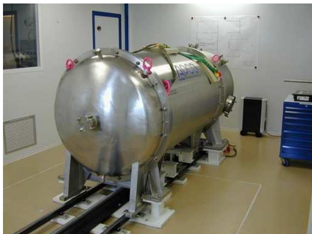
Рисунок 2. Спектрограф HARPS. Именно на нем были открыты наименее массивные внесолнечные планеты.
