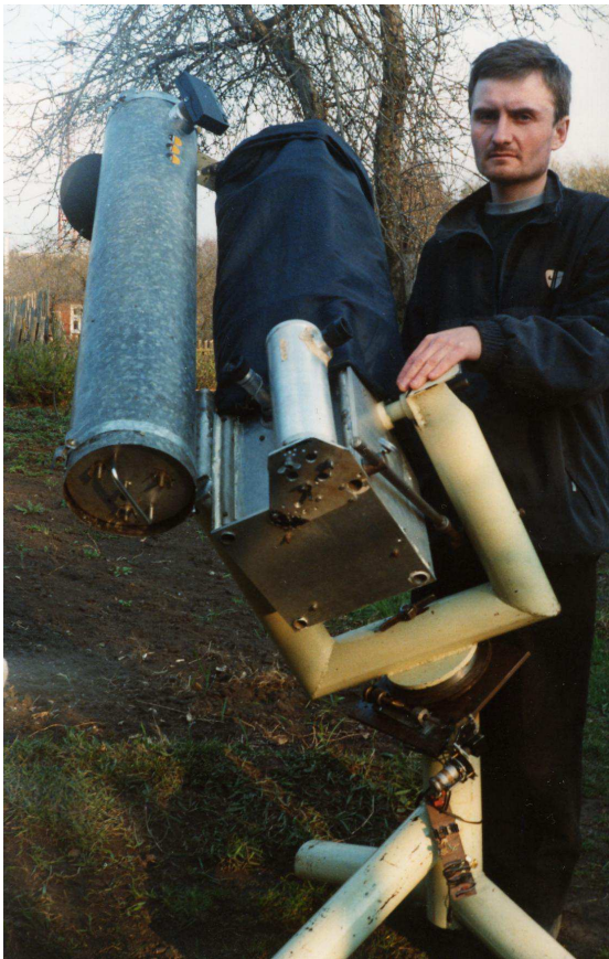
Телескоп системы Кассегрена, диаметром 200 мм с часовым электроприводом, построенный в 1995г. для фотографирования «Города» на Луне. Автор Кулешов Н.В.
